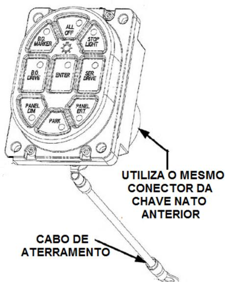
A nova Chave NATO foi apresentada nos EUA em 2002 e foi denominada “*Master Vehicle Light Switch*” ou, simplesmente, MVLS. Ela destina-se a substituir a anterior que surgiu na década de 50 e que é dotada de alavancas com acionamento mecânico que requer a operação com duas mãos.
